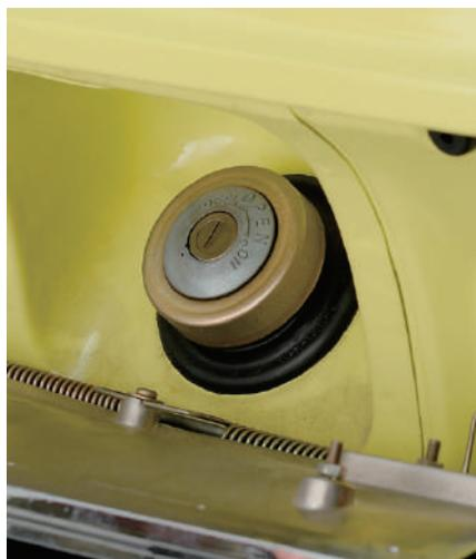
加油口位於車牌的後方。這是初期車型和掀背車型的獨有規格，在小改款後被移到後車柱的位置。
