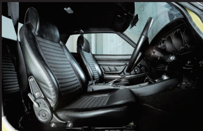
前座椅稍微設置較低，駕駛座和副駕駛座均採用3點式，自動繞繩的安全帶作為標配。
