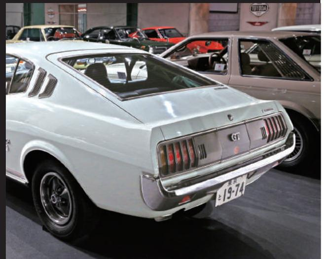
Liftback 的後視圖。配備大型尾門，可將後座放倒，使其可容納衝浪板的載貨量。
